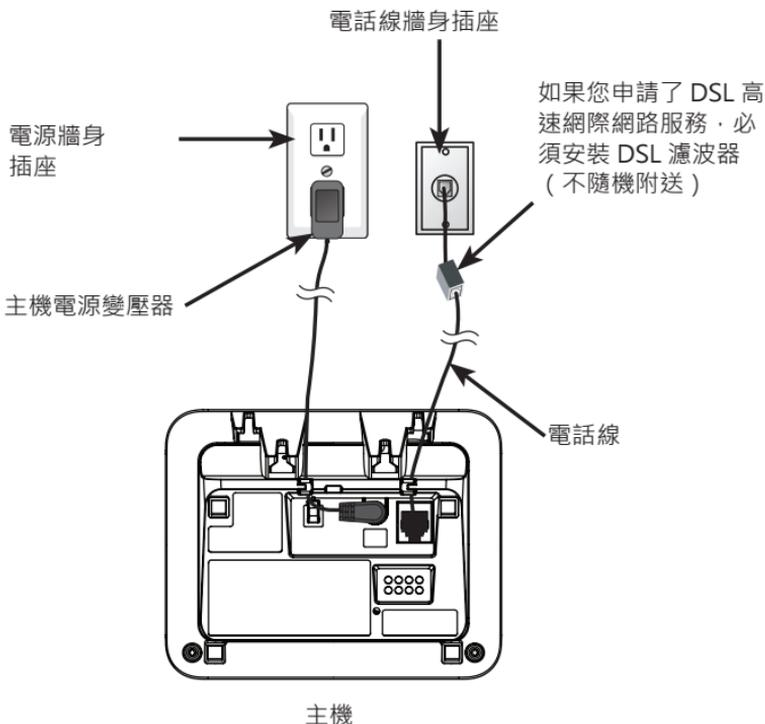
1. 把電源變壓器的直流插頭和電話線一端插入主機。
