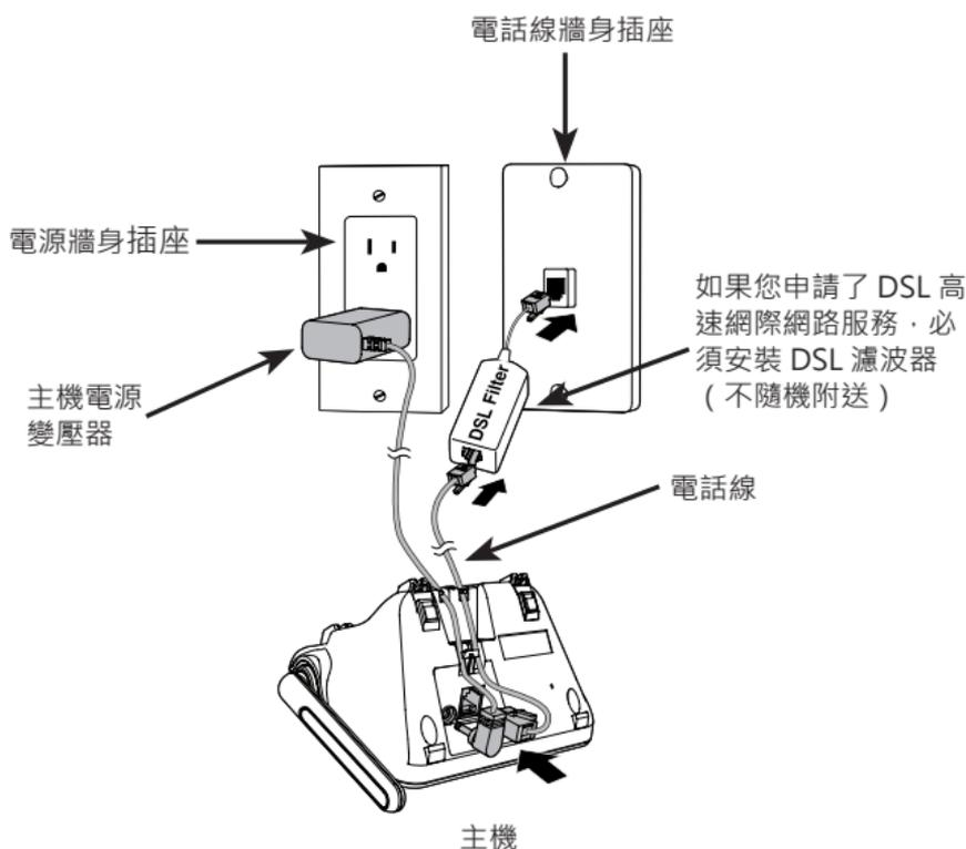
1. 把電源變壓器的直流插頭和電話線一端插入主機。
